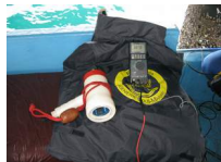
Figure 8 : Mesures de potentiels électrochimiques - Doralhé Djibouti
