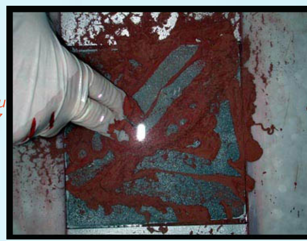
Figure 2 : L'application du revêtement n°7 est impossible
