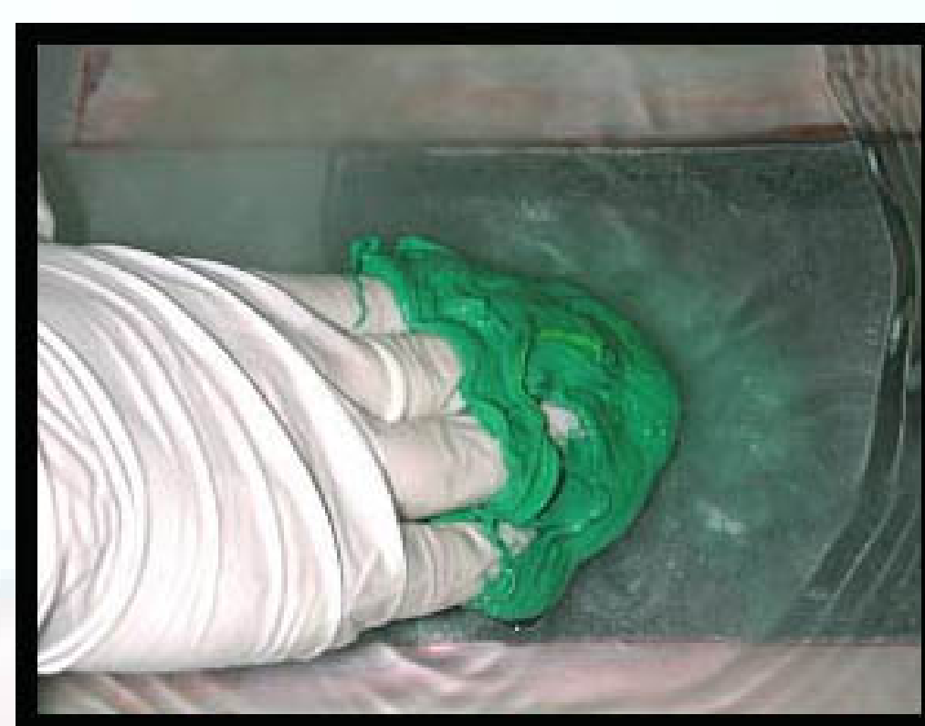
Figure 2 : L'application du revêtement n°7 est impossible
