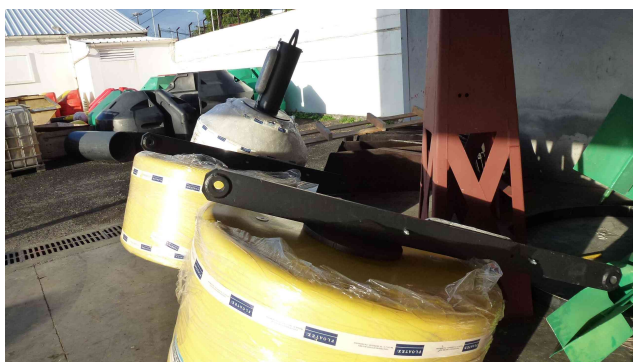
Figure 5 : Bouées subsurfaces de 0,6 \text{ m}^3 sur le parc de balisage
