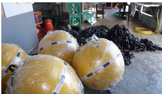
Figure 6 : Bouées subsurfaces de 0,2 \text{ m}^3 sur le parc de balisage
