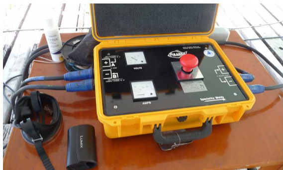
Figure 11 : Coupe circuit Piranha 400 A - Wharf de Futuna
