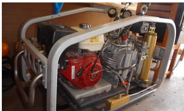
Figure 12 : Compresseur HP Bauer - Wharf de Futuna
