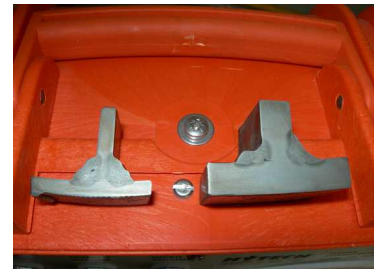
Figure 3 : Vue d'une soudure en coupe (pénétration) après sciage et meulage - INPP
