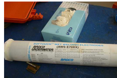
Figure 6 : Électrodes de soudage Broco Underwater SoftTouch
