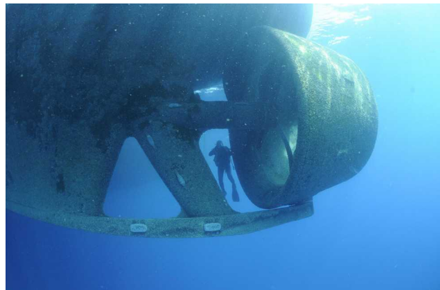
Figure 2 : Anodes sur un remorqueur de la SOMARA (photo Maxime Herbland)
